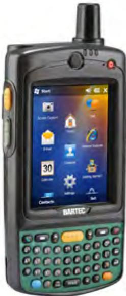
Der **Mobile Computer MC 75Ax<sup>ex</sup>-NI** und der **Mobile Computer MC 75A6<sup>ex</sup> HF-NI** sind ein 3.5G Worldwide Enterprise Digital Assistant (EDA) Gerät und wurden von BARTEC speziell für den Einsatz im explosionsgefährdeten Bereich der
